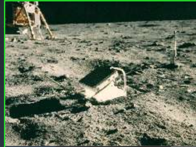
Apollo 11 retroreflector array
